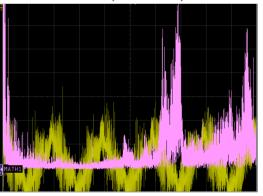
Erhöhte Rauschenergie ab ca. 18KHz
